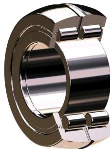
**NNC •••V** 型双向定位调心双列满装圆柱滚子轴承，具有外球面的表面，可以补偿由于轴倾斜和安装不精确引起的误差。两侧具有卡状环密封结构，滚子由两侧挡圈引导。内圈无挡边，内圈两侧各有一止动圈。该型轴承除承受径向负荷外，还可承受双向的轴向负荷。轴承的内圈和两侧的止推挡圈必须被轴向固定和支承，以保证其使用性能。
