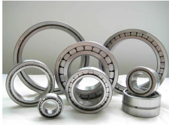
**满装圆柱滚子轴承**是为了承受重载荷而设计的。在同样宽度下，这种轴承与传统型带保持架轴承相比，具有极高的承载能力，径向截面小，可以节省空间，但转速相对较低。所有多列圆柱滚子轴承在外圈上有一润滑槽和润滑孔。
