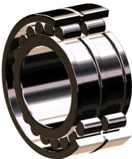
**NCL •••V** 型双列满装圆柱滚子轴承，外圈可以相对于内圈做双位置，参考“S”值。外圈滚道中间放置有止动圈，保证运输与配过程中内外圈不分离。在装配时外圈中间的止动圈不能承受任轴向负荷。
